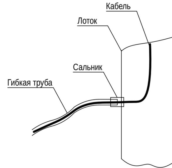
Конструкция вывода кабеля из лотка.
