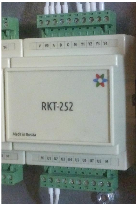
Модуль ввода-вывода RKT-252 предназначен для сбора данных и подключения исполнительных устройств на объектах автоматизации систем вентиляции, отопления, кондиционирования и других инженерных систем зданий. Прибор управляется с помощью программируемого контроллера, персонального компьютера или другого управляющего устройства.
