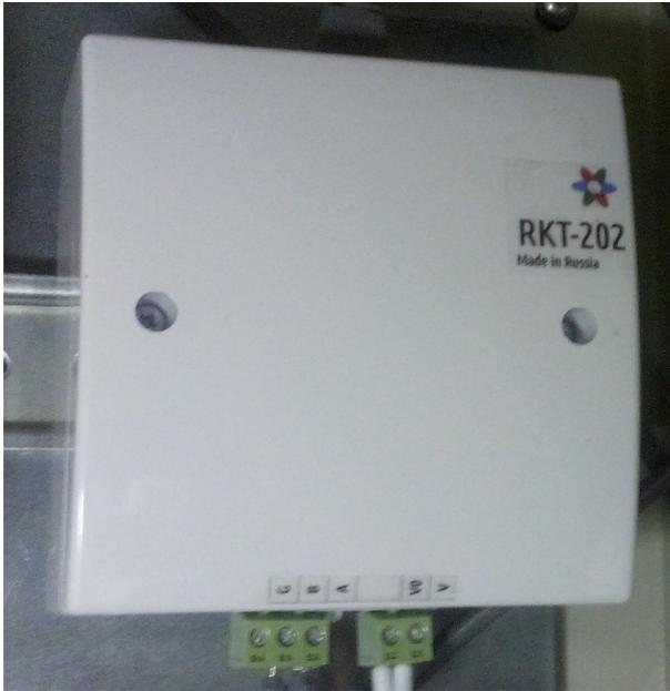
Контроллеры и модули расширения серии RKT предназначены для автоматизации и диспетчеризации систем вентиляции, отопления, кондиционирования и других инженерных систем зданий.
